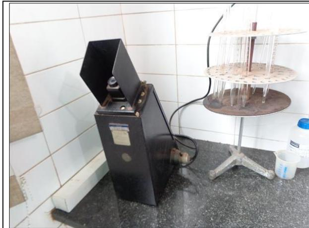
**Foto 9.** Equipamento para determinação da cor
